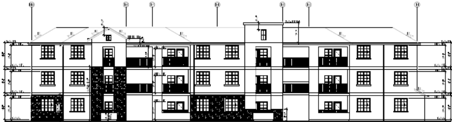
REAR ELEVATION SCALE: 1/8" = 1'-0"
